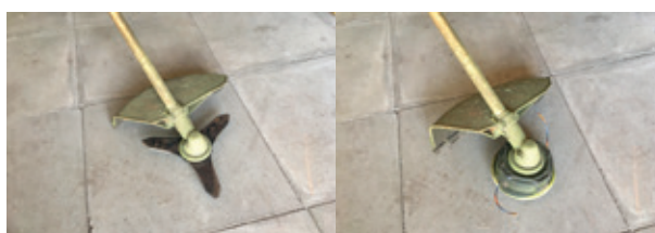
Met een bosmaaier met slagmes (links) worden de planten meer afgesneden en zijn daardoor beter af te harken. Dit is lastiger als er met een bosmaaier met draadkop (rechts) gewerkt wordt, want die versnipperd het maaisel teveel.
